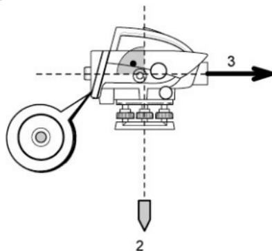
补偿器改正了对水平视线的垂直轴倾斜影响，因而仪器的照准视线是严格水平的。
