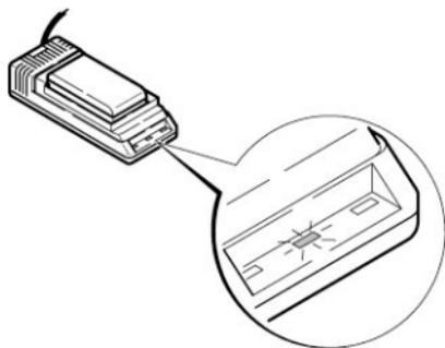
绿灯闪烁表明充电完成。将充满电的电池插入仪器电池仓。
