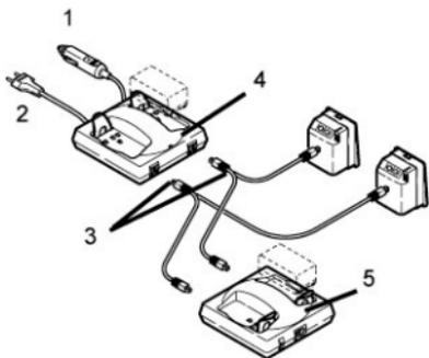
专用充电器 (GKL122) 可同时对 4 只电池充电。充电器接在 230V/115V 交流电电源或 12V/24V 汽车电缆上, 可对 2 只大容量电池、基本电池充电和 2 只带 5 针插口的电池充电。用适配器 GDI121 可充 4 只基本电池。
