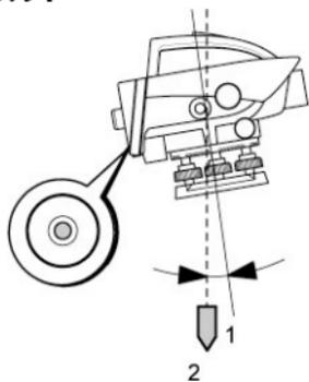
圆水准器气泡居中后，仪器基本上处于水平状态，但仍存在微小的倾斜，这就是垂直轴倾斜。
