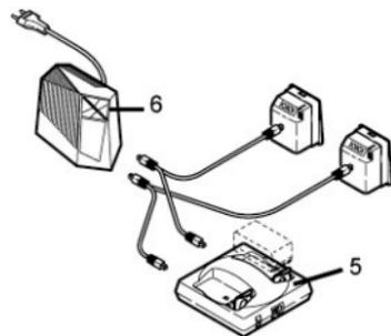
充电适配器可接到 GKL122 大容量充电器, 也可以接到 GKL23 充电器。GKL23 充电器可同时对 2 只基本电池或 2 只大容量电池充电。
