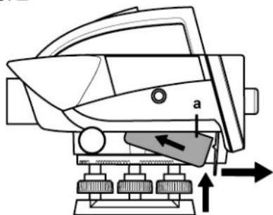
首先向物镜方向插入电池（如 a），然后如图中显示屏方向推操作杆，压电池到锁紧位置。
