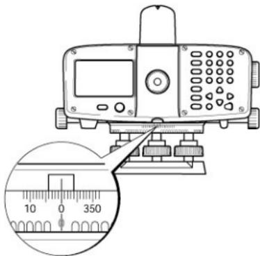
仪器装有可旋转的水平度盘，角度单位是  $360^\circ$ ，按  $1^\circ$  的间隔划分。
