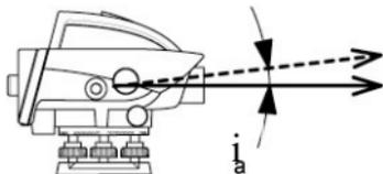
倾斜误差 ( $i$ ) 是实际视线与理想的水平视线之间的夹角。倾斜误差可通过检验水准仪确定。
