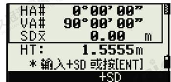
如果您把棱鏡貼近圓物件表面進行距離測量，在按 [ENT] 之前先按 +SD 按鍵，以消除棱鏡除偏移量誤差（從貼近點到已測表面）。
