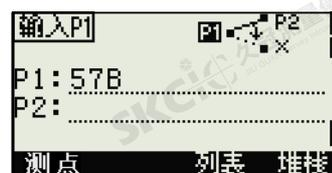
輸入加減角度，輸入到達一條由 P1-P2 定義的基線的水準距離和垂直距離。
