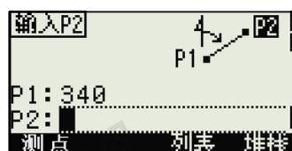
第一點到第二點的方位角、水準距離和垂直距離顯示出來。
