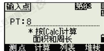
輸入的第一個點和最後一個點首尾相接，使面積閉合。您必須按照這批點的定義順序輸入點。最多可以輸入 99 個點。
