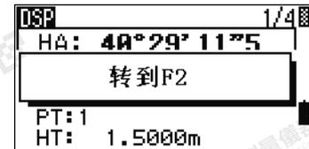
為了能夠從雙盤測量中調整水平角，在設立測站期間也需要用雙盤測量後視點。
