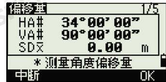
可以在基本測量螢幕 (BMS) 上記錄角度偏移量。距離測量之後，旋轉照準部和 / 或望遠鏡。然後按 [ENT] 以記錄帶更新角度值的已測距離。如果使用此方法，角度偏移量的維數不存儲為 CO 記錄。如要存儲 CO 記錄，使用偏移量功能。
