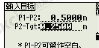
5. 如果確實輸入了 P1-P2 距離，QA 螢幕出現。輸入的值與已測的距離進行比較，以檢查觀測的準確性。
