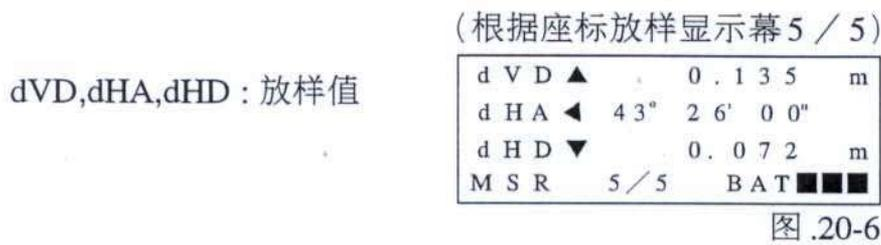
• 4/5 幕 (照准点坐标) 5/5 幕 (座标放样) 和 1/5 幕 (测量数据放样) 可以用来输入数据 (详细内容请参考 28 页)
