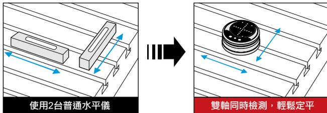
雙軸可同時檢測，相比傳統需使用2台水平儀才能夠進行的工作，成本及時間均大幅縮減。
