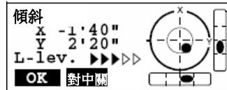
4. 使用腳螺旋調整三腳架上的儀器位置至使對中鐳射點對準測點標誌中心。
