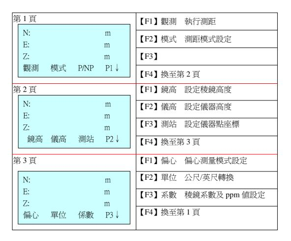
《3》至第2頁按【F3】測站輸入儀器點的座標,若要包含高程測量請按【F1】輸入正確的稜鏡高度及按【F2】輸入正確的儀器高,設定完成回到第1頁
